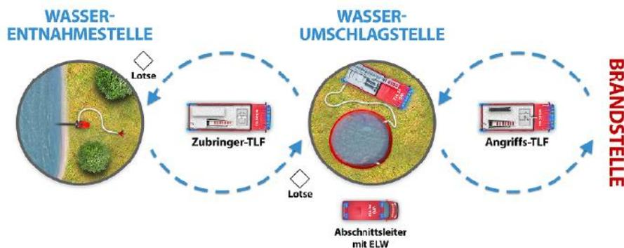
Abb. 6.7: Doppelter Pendelverkehr mit Tanklöschfahrzeugen [1]
