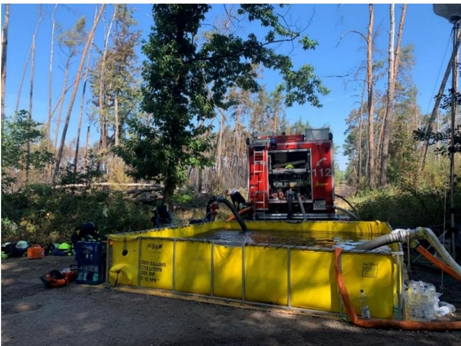
Abb. 6.8: Wasserübergabepunkt mit mobilem Wasserbehälter
