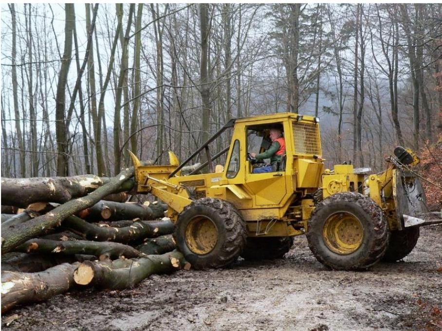
Abb. 8.3: Seilschlepper bei Polterarbeiten [Hessen Forst, K. Eidmann]
